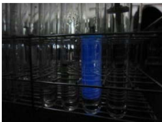
実験1 ルミノールによる発光実験
