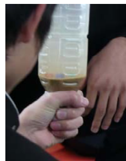
地盤液状化実験
