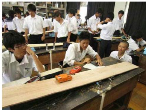
斜面を用いた重力加速度の測定実験
