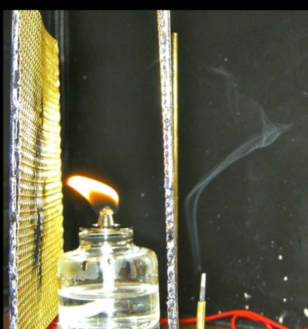
↑マイナス ↑アース電位 アース電位の電極外部で煙のたなびく向きとは逆に外向きに流れている
