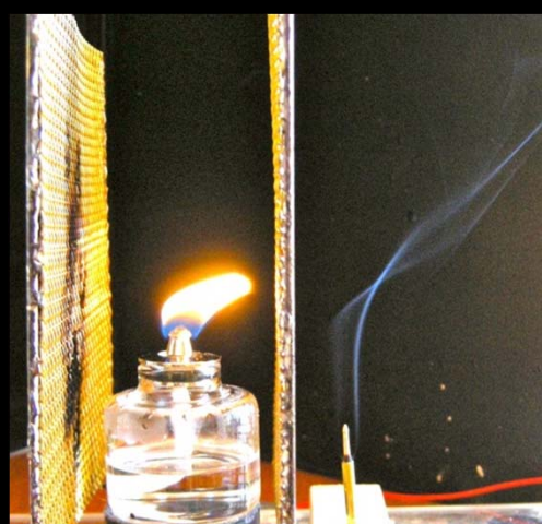
↑プラス ↑アース電位 電場の向きにたなびく炎によって電極外部にも大気の流れが生じている
